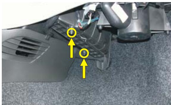
**(PL)** Odkręcić wkręty pokrywy filtra, usunąć pokrywę
